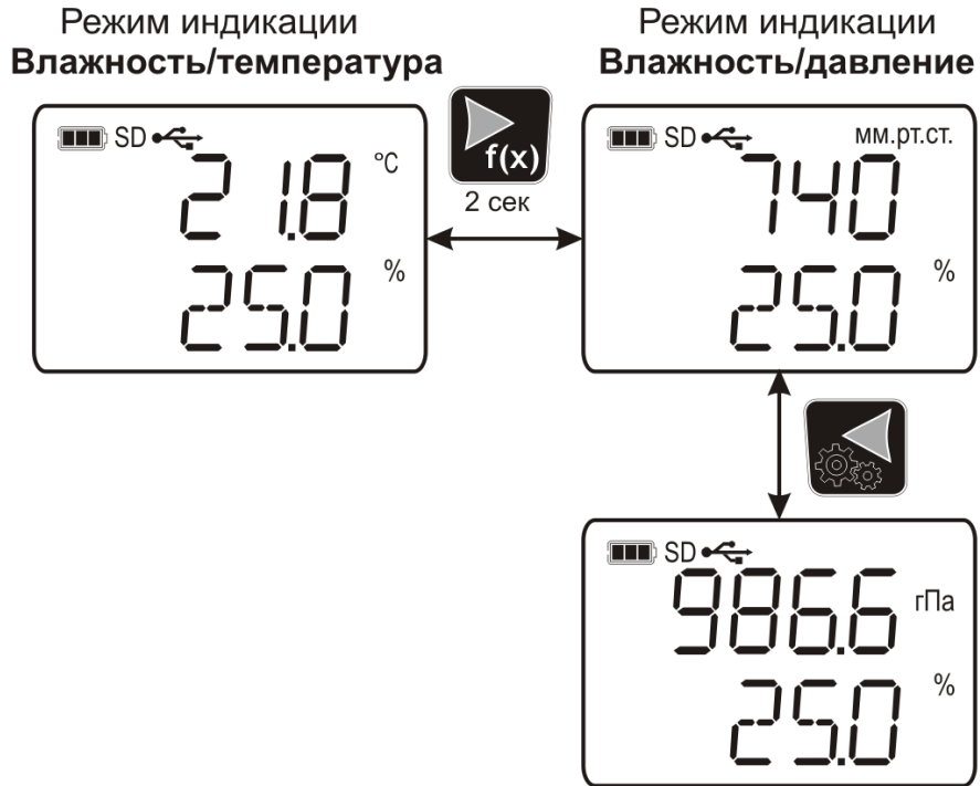
Рисунок 5.2 Переключение режимов индикации ИВТМ-7 М 6-Д-1
