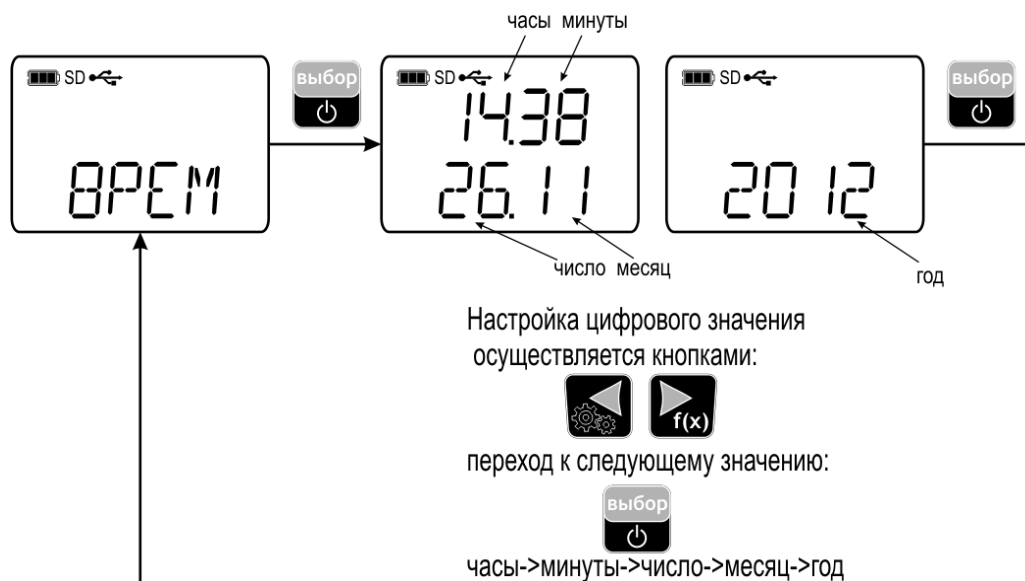
Рисунок 5.5 Настройка часов реального времени
